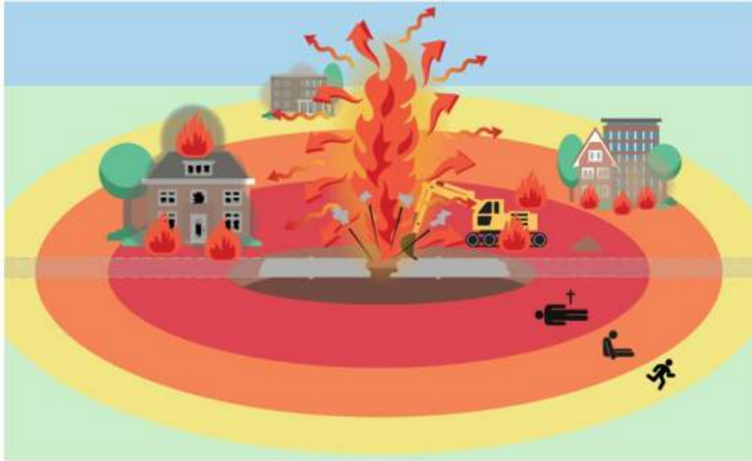
Figuur 2.2 Voorbeeld fakkelbrand bij hogedrukbuisleiding: hogedrukaardgasleiding
