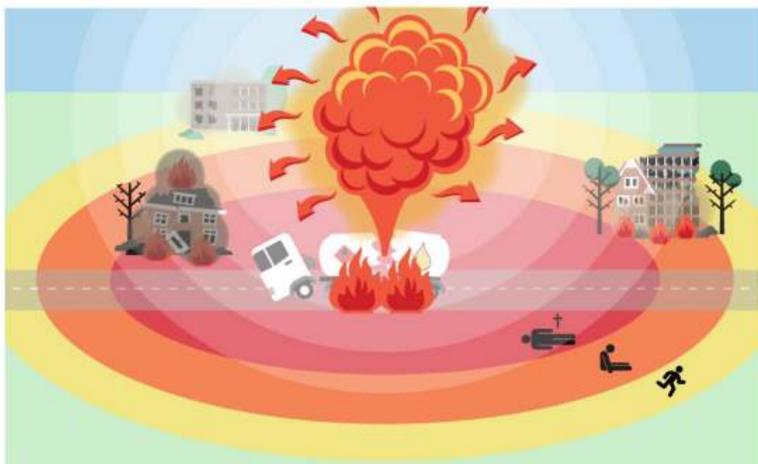
Figuur 4.2 Voorbeeld warme BLEVE van een tankwagen LPG
